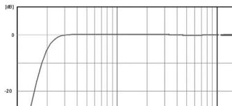
Illustration 6 : Filtre en plateau >6 kHz pour les fréquences supérieures à 6 kHz
